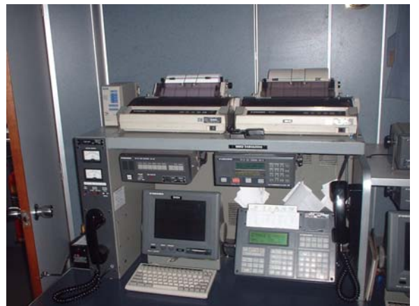
巡視船 San Juan 通信室(GMDSS 機器)
