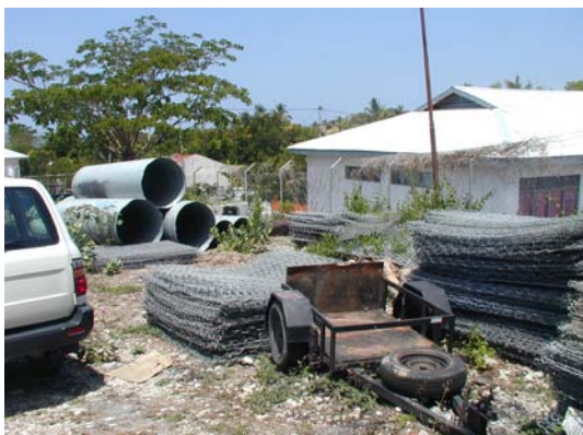
バウカウ地方道路事務所にある道路排水用の コールゲートパイプと布団籠用の鉄網等の資材
