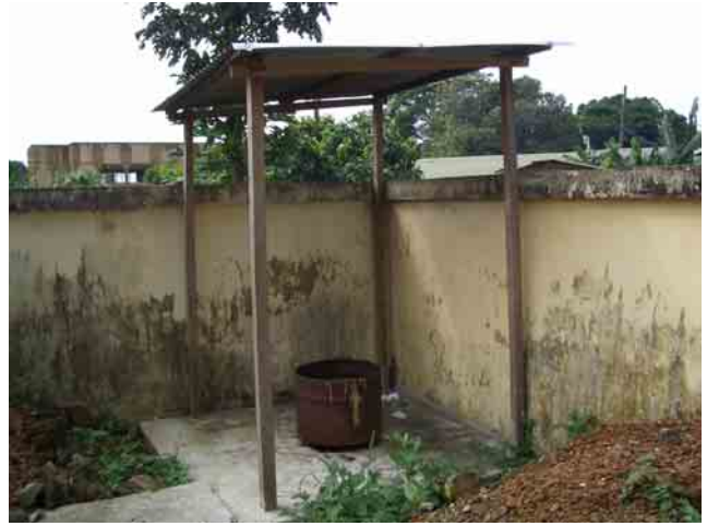
医療廃棄物の焼却用ドラムカン (焼却炉のない施設)
