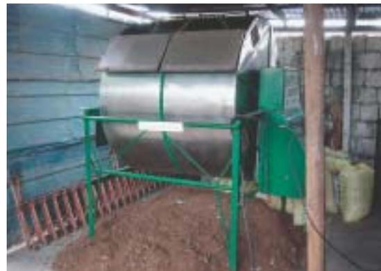
写真2-7 小規模コンポスティング機器の例（マニラ）
