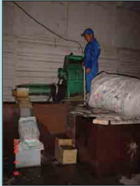
樹脂袋リサイクル工場(破碎機)
