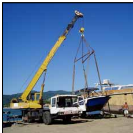
写真— 1 8 15 トン吊りクレーン車
