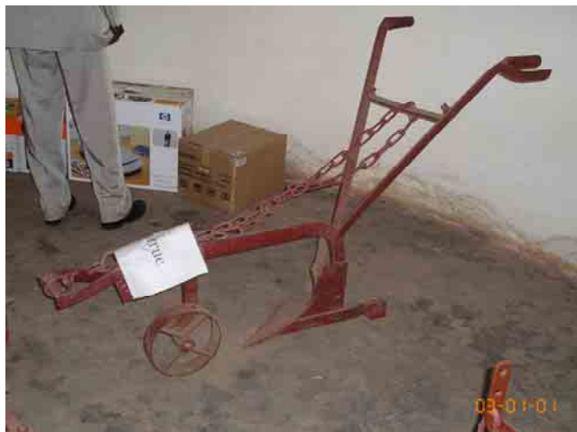
写真13 NGO(RGTA)が町の鍛冶屋を指導し、製造している農具(牛耕用プラウ)
