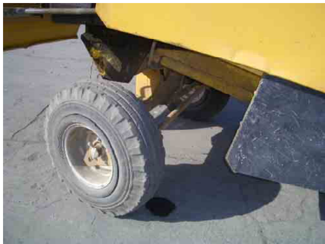
写真13 平成13年度（2001年度）2KRにて調達されたフィンランド製コンバイン。タイヤがパンクしたが、純正部品ではなく、バザールで入手した類似品にて対応している。
