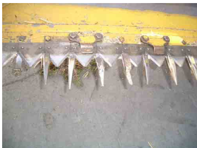
写真12 コンバインの刈取り部分。刃の部分に損傷があるが、この程度であれば、農機の所有者はバザールで入手した類似部品を加工して対応している。
