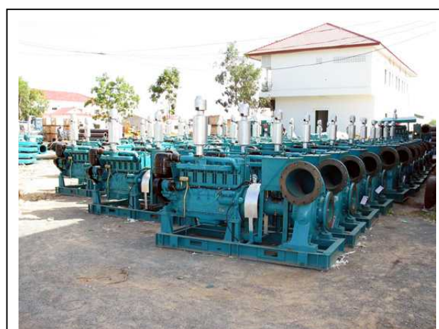
写真:水資源気象省灌漑農業部で組み立て中のディーゼルエンジンポンプセット(台車による移動式)
