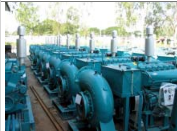
写真-9: 水資源気象省(MOWRAM)灌漑農業局が配置している灌漑用ディーゼルポンプ。MOWRAMは灌漑用のエンジンの組み立て工場を運営している。これらのポンプは重力灌漑地区における干ばつ時の緊急補助灌漑用として広く利用されている。
