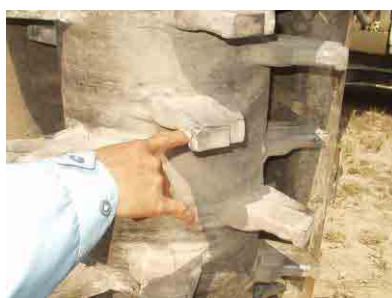
爆発後の Edge (損傷無し)
