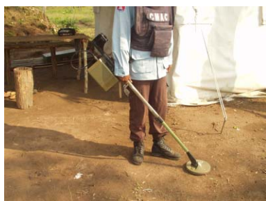
地雷探知機 F1A4 Minelab
