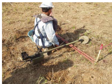
除去測定棒を 50cm 前方に移動
