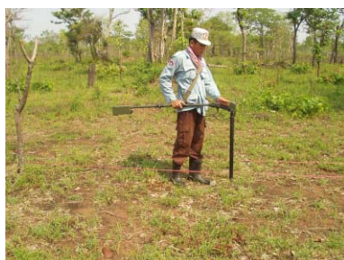
Bomb locator での探査状況
