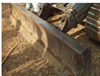
Brush Cutter の前面に装置された排土版
