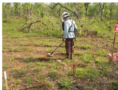
地雷原探査状況 F1A4 minelab 使用
