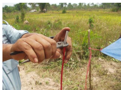
地雷の誘爆処理、導火線にヒューズ ※ 設置
