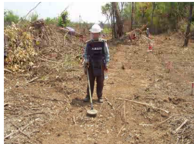
地雷探知機 F1A4 Minelab
