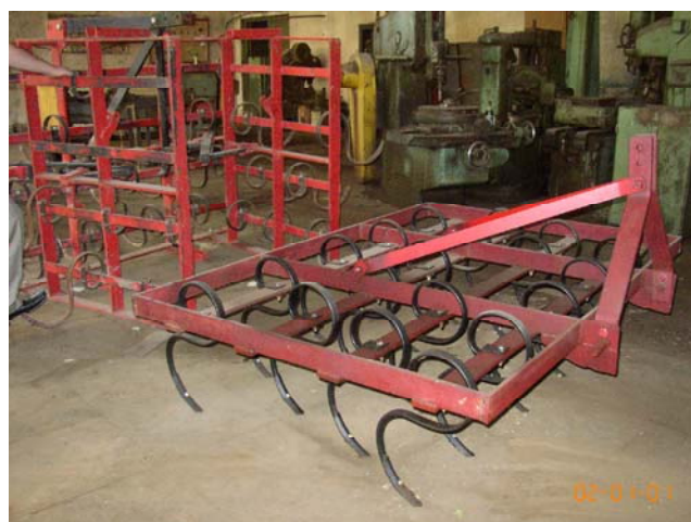
写真10 サービスエージェンシーの技術者が作成したタインカルチベーター。
