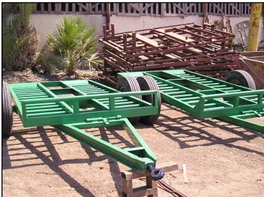
写真-3 Diarb(ジャルブ) AMSにて 農機具運搬用ト レーラー。トラクター輸入時の固定用架台 (後方山積みされている資材)をフレームに 利用して、トレーラーを製造。
