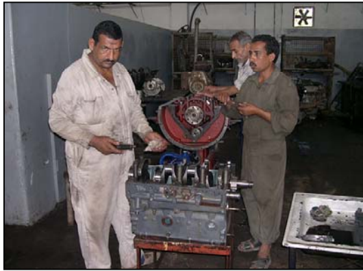
写真-1 Tukh(トゥフ) AMS(農業機械化ステーション)にて トラクター用エンジンのオーバーホール作 業。
