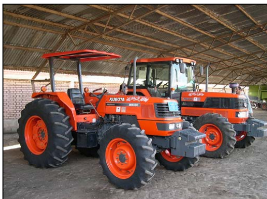
写真-14 Kotoor(クトール) AMSにて 2002年度の2KRで調達したクボタ製トラクター 手前M-9000(87hp)、奥M-110(110hp) (9月 12日訪問時1988時間使用)
