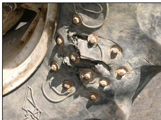
写真-17 Sakha(サハ) AMSにて トラクター用タイヤは高額で新規調達が困難 であるため、裂けても鉄板及びボルトで固定 (縫い合わせ)し使用。
