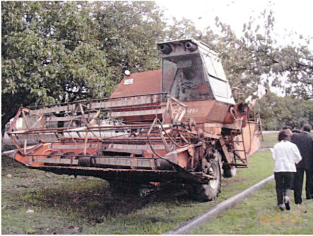
旧ソ連製コンバイン NIVA (ニバ)。 耐用年数を超過して20年以上使用されており、劣化が激しい。
