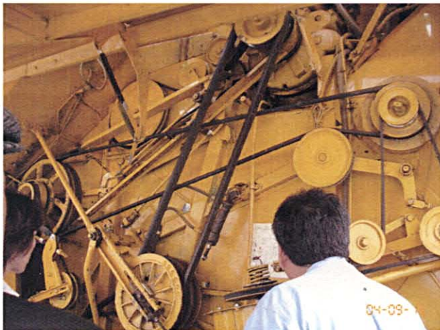
コンバイン内部の様子。 消耗の激しいベルトは交換頻度が高く、エンドユーザーからはS/Pが高額であることに不満が寄せられた。
