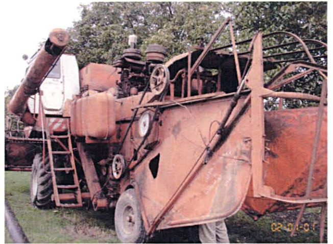
同左、現在も修理して使用されているが、故障が多く、収穫時のロスは25%にもなる。
