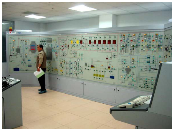
機関室シミュレータ：ミミックパネル部
