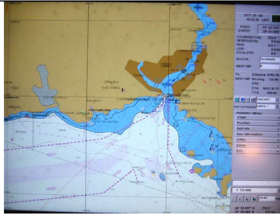
ECDIS : 電子海図表示装置 航海部追加機能の一つ (図はボスポラス海峡入り口)
