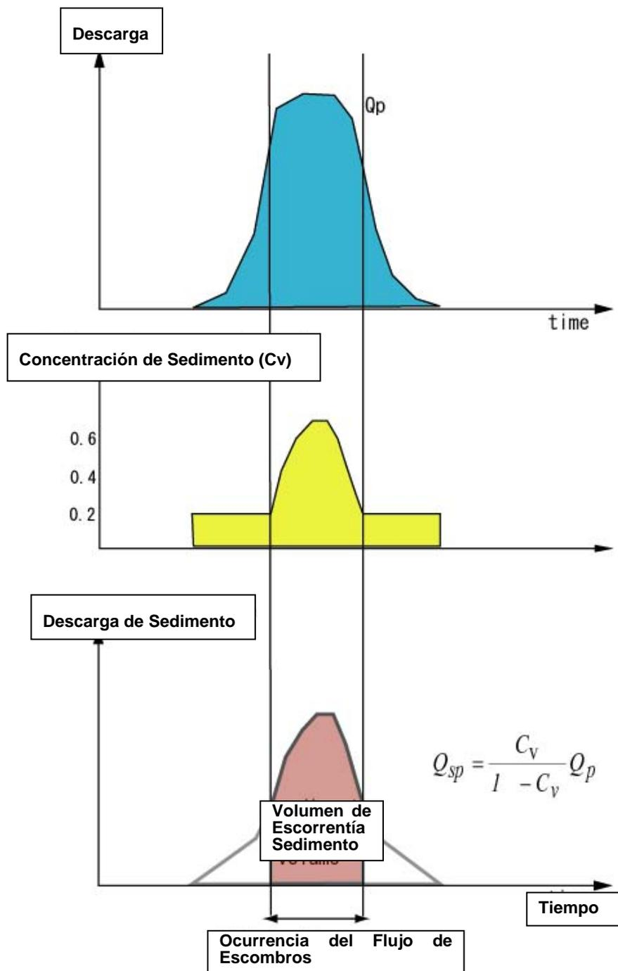
Figura S12-2.4.1 Gráfico de la Descarga de Sedimento
