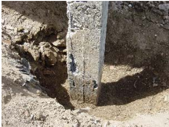
Foto 6.9 Falla Columna Larga Modelo 2
