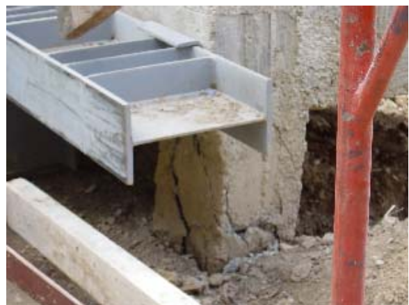
Foto 6.6 Falla de Esquileo Columna Corta Modelo 2 (1)
