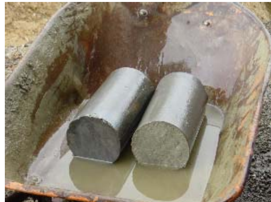
Foto 3.12 Cilindros de Prueba de Concreto
