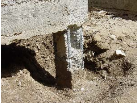
Foto 6.7 Falla de Esquileo Columna Corta Modelo 2 (2)
