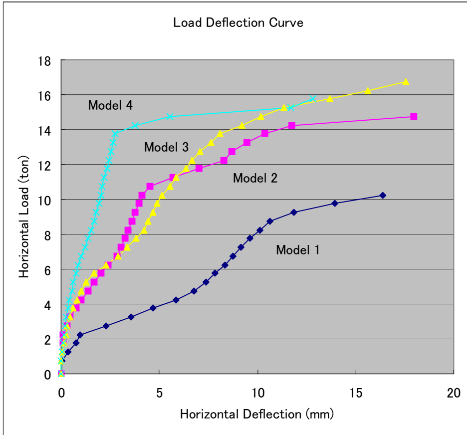
Figura S7-6.2.5 Curva de Desviación de la Carga
