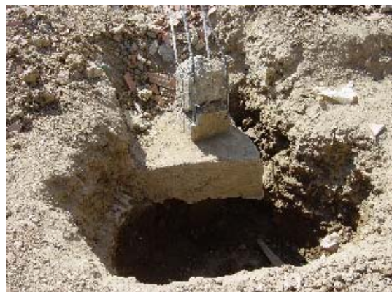
Foto 6.8 Esquileo de Quiebre Columna Corta Modelo (3)
