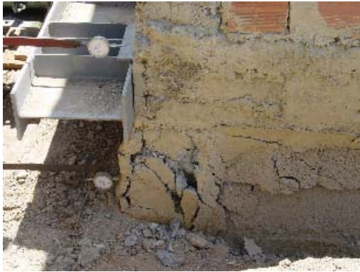
Foto 6.19 Falla de Esquileo de Columna y Pared Bloque Concreto con Barras Reforzadas (1)
