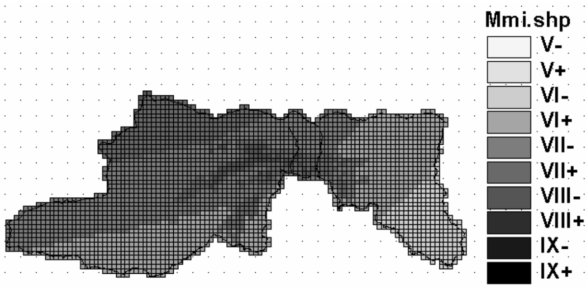
Figura S3-4.3.1 Intensidad Sísmica Estimada para el Terremoto de 1967
