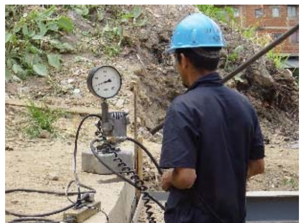
Foto 3.5.51 Marco de Acero para Transferencia de Carga
