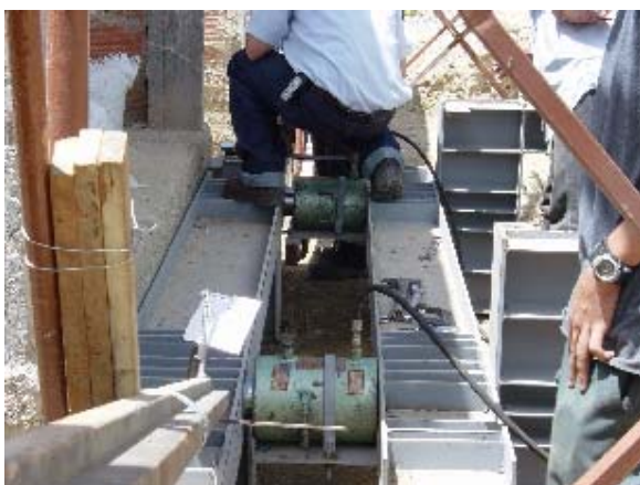
Foto 3.5.51 Marco de Acero para Transferencia de Carga
