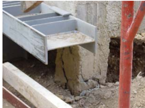
Foto 3.5.59 Modelo 1 Falla de Columna Larga
