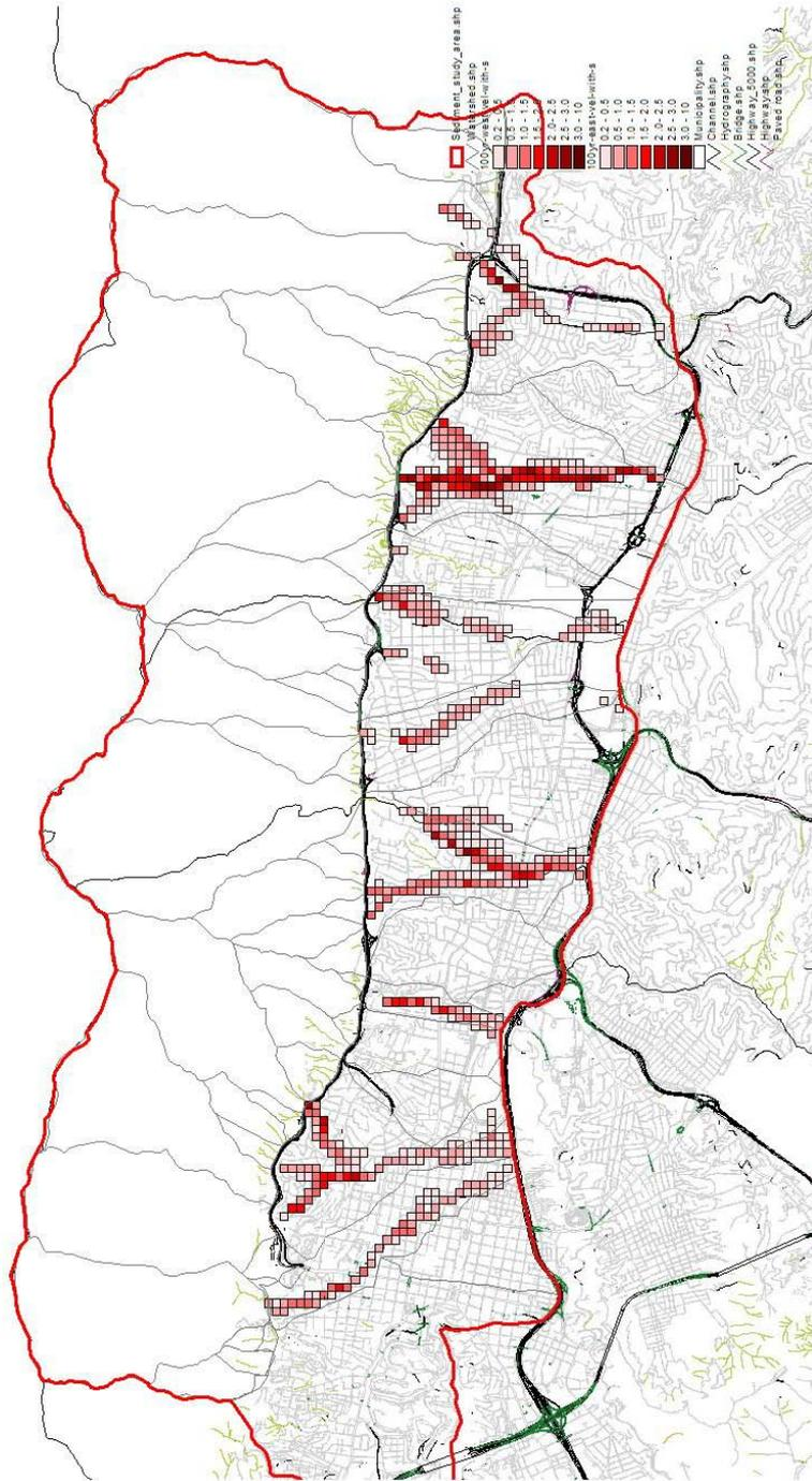
**Figura 4.1.8 Velocidad en un Período de Retorno de 100 años bajo Condiciones Reales**
