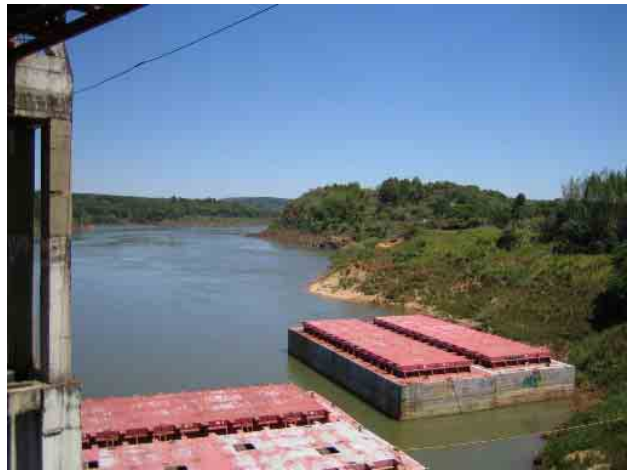
写真 6-4 No.2 Torocua 港 (民間建設管理港) (他港同様、シューターから写真の穀物用バージに大豆を積み替え、船の牽引によりパラナ川を下る)
