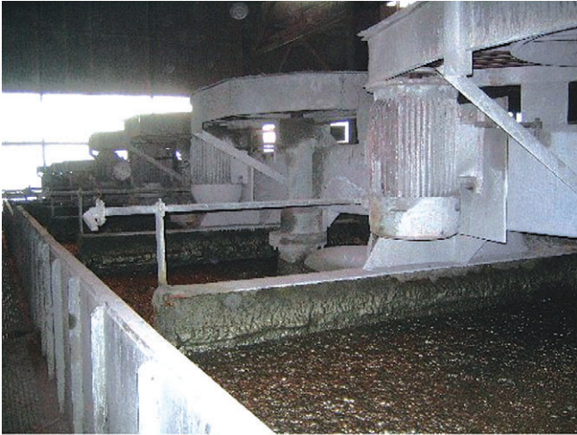
Krivelj 露天掘り鉱山選鉱場浮選機
