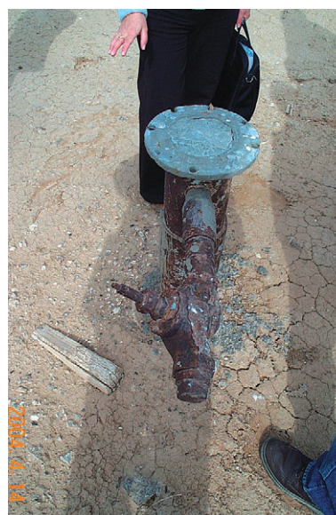
写真4 イ．の方法により閉止された油井
