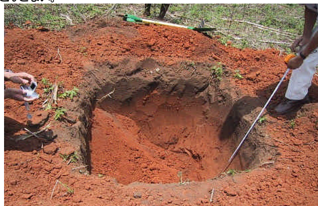
【サイト】試掘。黒色の耕作土(表土)の下は粘土質土。
