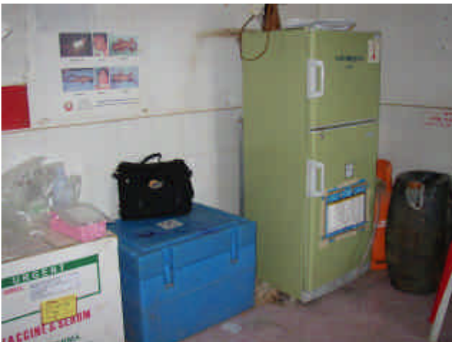
写真3：ワクチンを保管しているガス・電気式冷凍冷蔵庫とコールドボックス（ポイ・ペトヘルスセンター）
