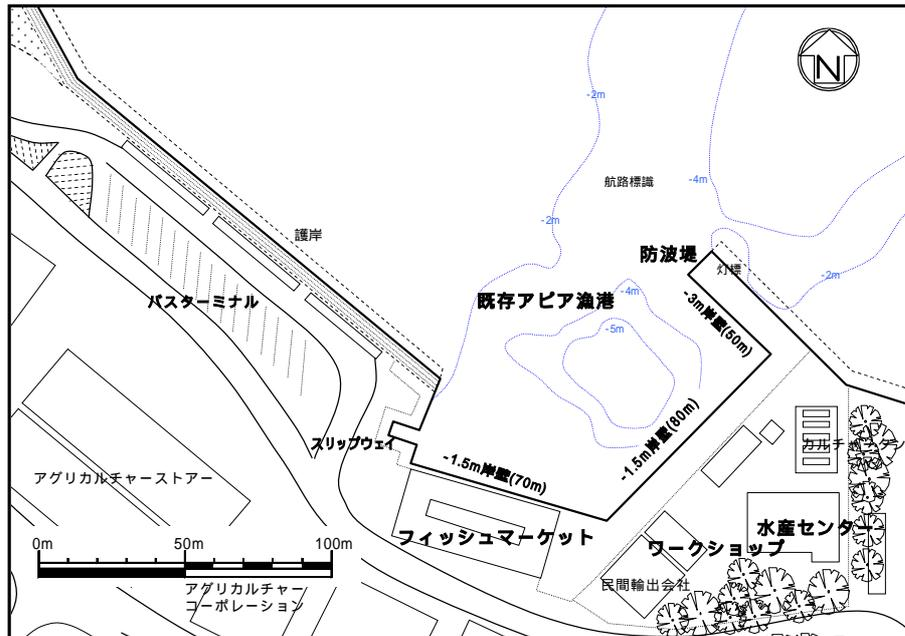
図 2-1-4(1) 既存アピア漁港の施設平面図
