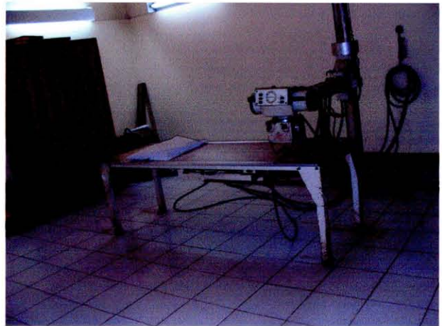
スダルソ州立病院（一般撮影 X 線装置） 設置後 25 年以上経過し老朽化が著しい
