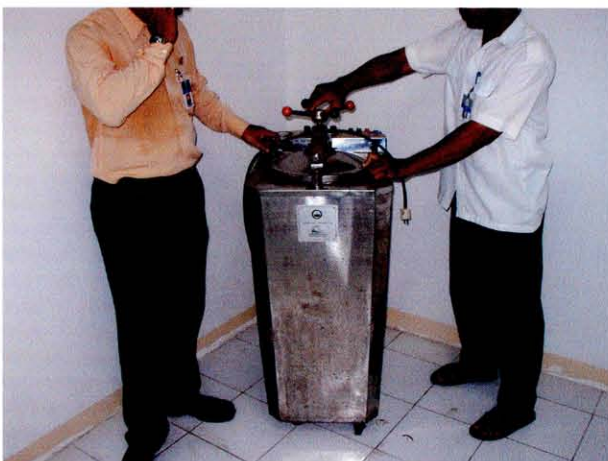
プマンカット県立病院（蒸気滅菌器） 蒸気滅菌器は老朽化のため故障、使用できず
