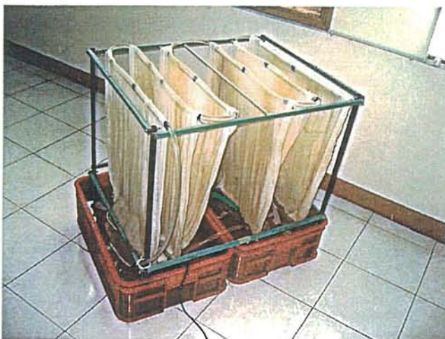
写真 11 : 空調装置 (湿度調整)
