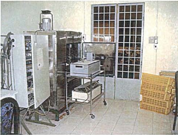
写真 3 : 豪州デザイン蒸熱処理装置一式 (温度・湿度調整不 調で使用困難)
