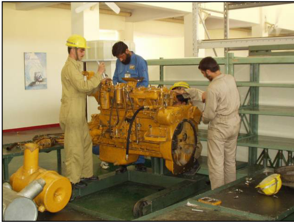
メカニックコースⅡエンジン実習の様子 9年前に調達した供与機材のエンジンを使って、エンジンの分解・再組立作業実習を行っている。
