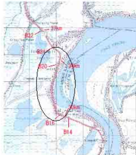
図 2-5-4 メコン川の河岸浸食
