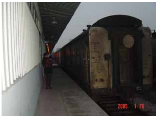
図表 84 : 列車端の機械冷蔵車（18両中、2両を連結）
