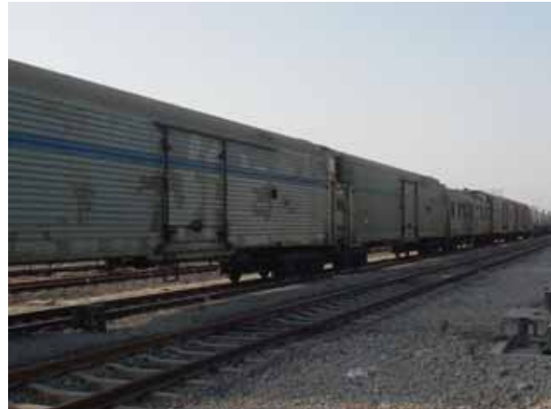
図表 20 : B22 型機械冷蔵車 ( 済南西駅構内 )
