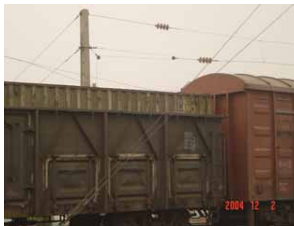
図表 15 : コンテナ積載サイドの小扉(3つ)。 (注)小扉は、バラ物の取卸に使うことができる。
