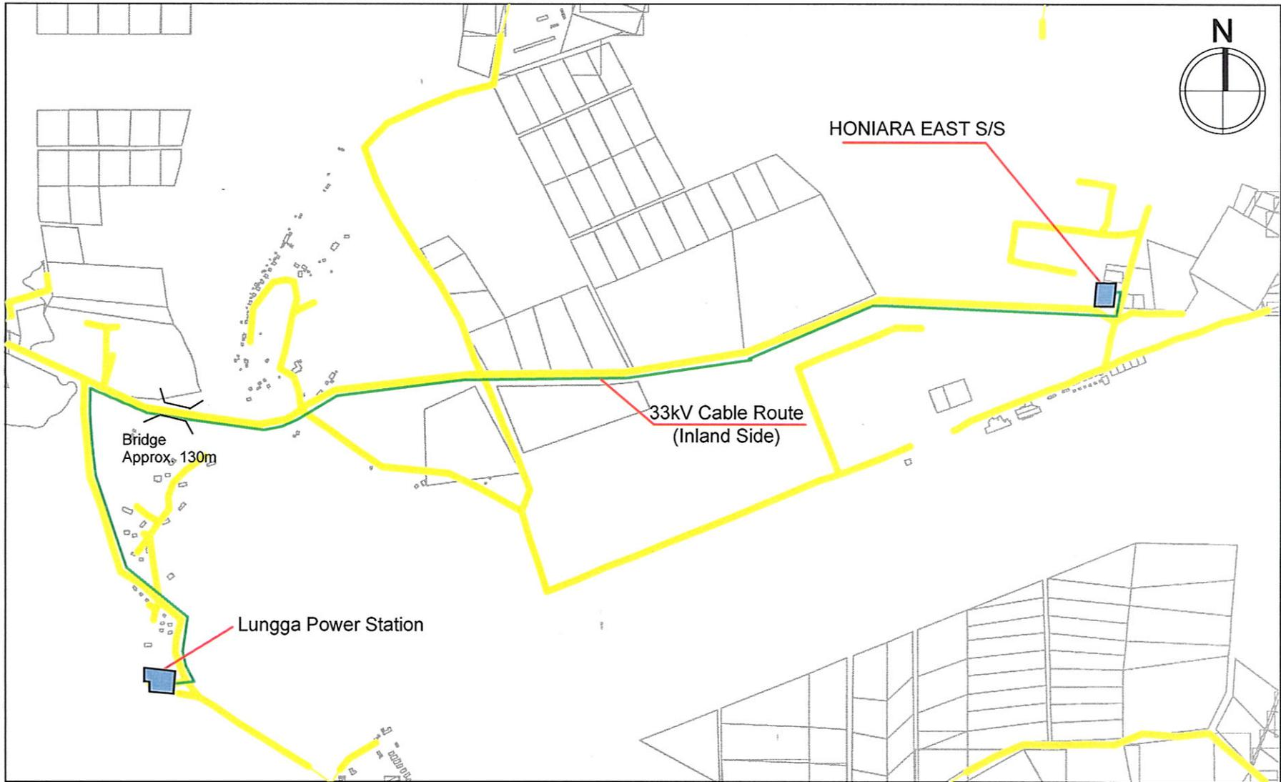
D-G01 : 33kV ケーブル・ルート図 : ルンガ発電所～ホニアライースト変電所
