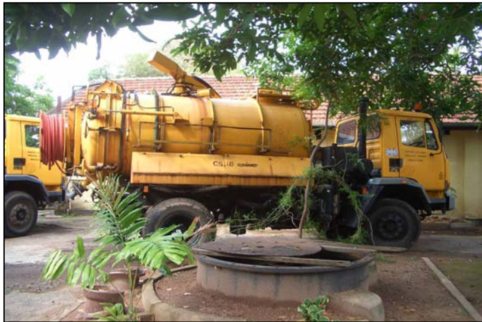
写真-01：NWS&DB保有の高圧洗浄吸引車 ・ワラワッタポンプ場で保管されている
