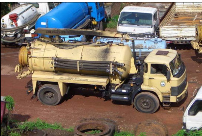
写真-03：CMC所有の高圧洗浄吸引車 ・マリガカンダ事務所で保管されている
