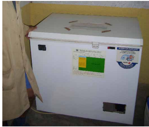
ワクチン保存用の冷蔵庫 (電源はソーラー)
