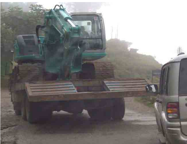
幅員の狭小な国道をトラックによる建設機械の搬送が行われている。
