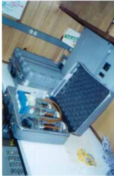
Figura 5.2 Kit para calibración de medidores de flujo en las estaciones de monitoreo
