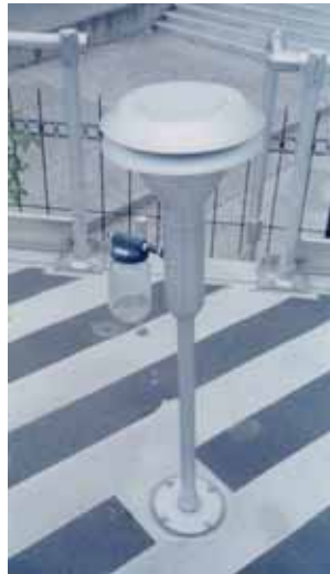
Figura 8 Toma de muestra de un analizador automático de partículas
