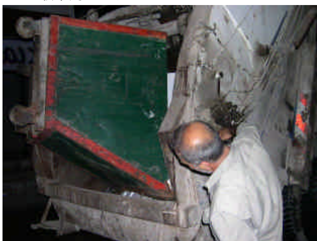
不適当なコンテナの為、車両に負担がかかっている。
