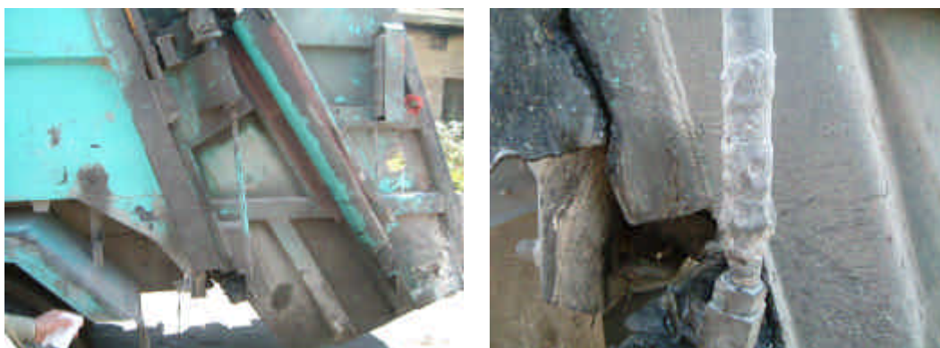
図 6.2-1 ハイドロリック支柱の不具合
