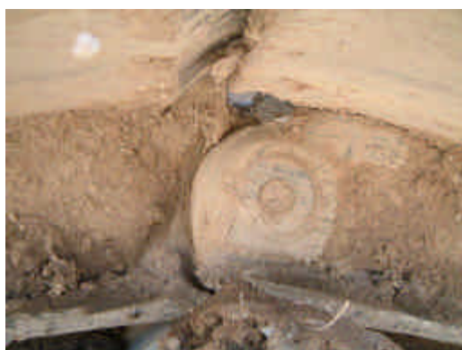
図 6.4-3 ブルドーザチェーン部のクラック(中央)
