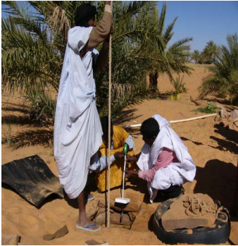
地下水位モニタリング
