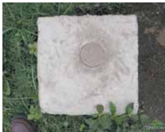
パカヤ火山に設置したGPSの地殻変動観測点
