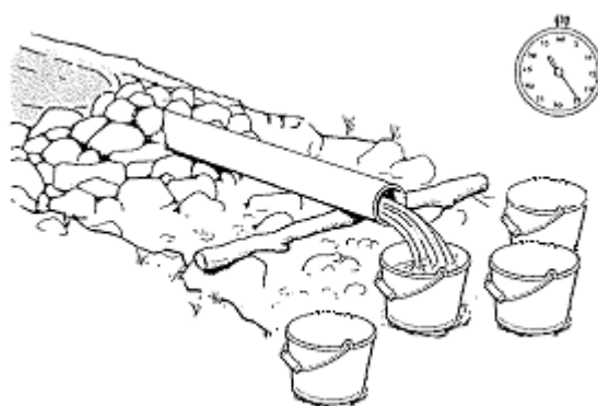
図 2-3 実測による流量測定法
