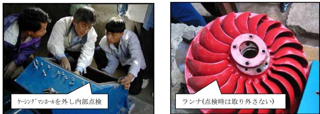
図 5-4-1 水車の内部点検
