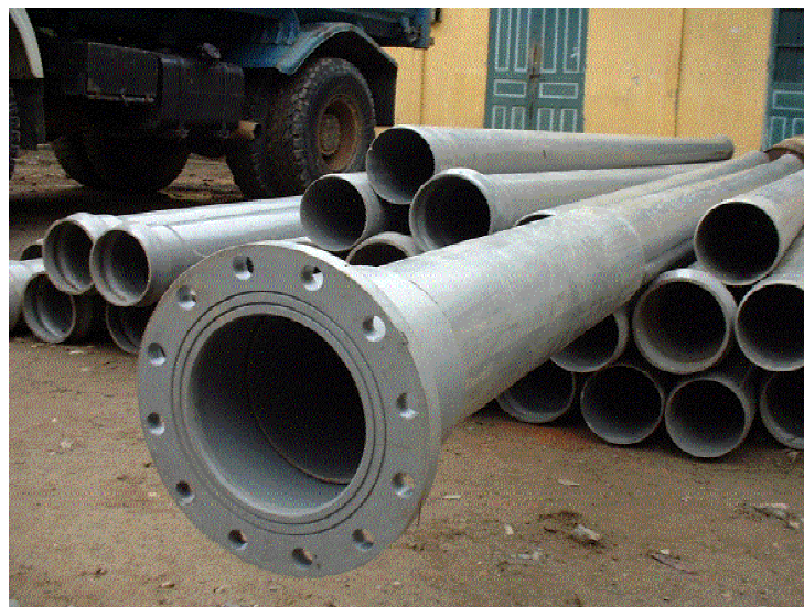
図 3-3-10 PVC 管とフランジ部
