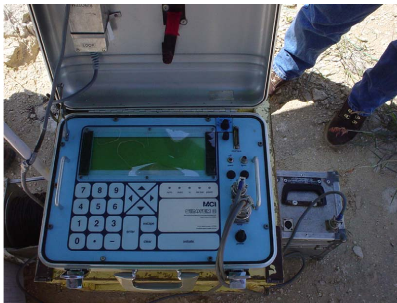
Figura K-1: Equipo TEM (SIROTEM-S)
