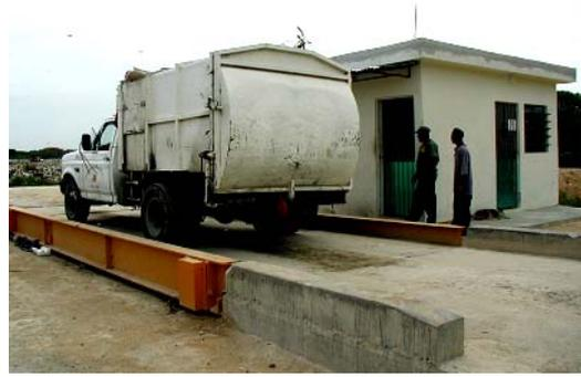
*La báscula fue instalada a la entrada del sitio. Se estableció un procedimiento para el pesaje, por ejemplo, la cuadrilla, con excepción del conductor, deberán bajarse del vehículo, los vehículos deberán posarse y salir del área de pesaje lentamente.*
