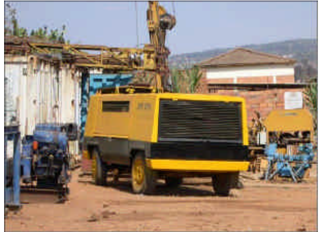
ルワンダ国唯一の民間井戸掘削会社 牽引式高圧コンプレッサー(ハンマー掘り用)
