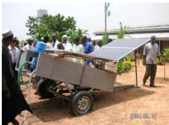
写真 4-3 Wawan Fari 村 (レベル-PV) USAID/ソーラー電化村 農業用モバイルソーラーポンプ
