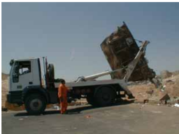
ヤルムク中継基地 ホイストトラックからのゴミ積替作業
