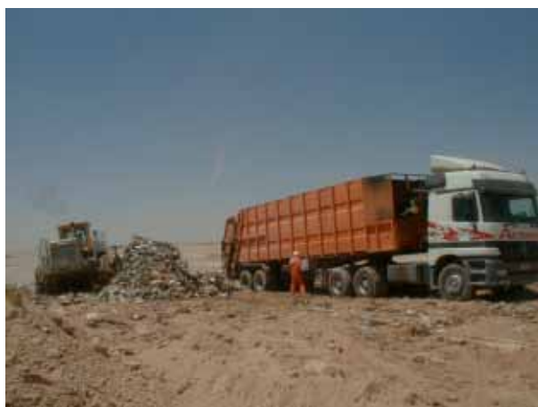
マドナーガバウイ最終処分場(3) 圧縮機能付トレーラーからのごみ排出作業
