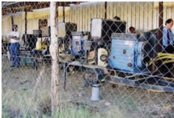
写真 3：ハフォソ中央倉庫外部に保管されている移動式灌漑ポンプ
