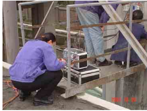
贵阳水泥厂 (SO 2 采样近景-2)
