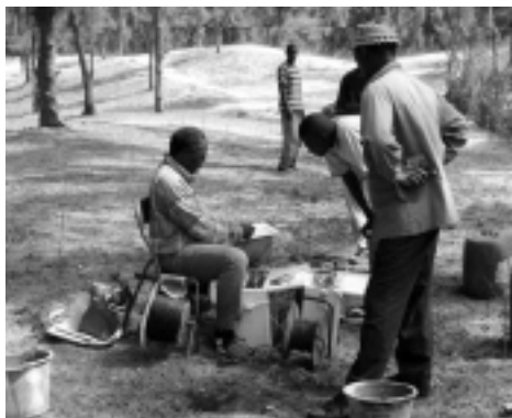
図 2-5: 電気探査の実施状況
